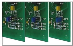
1 RPM/mV 2 RPM/mV 4 RPM/mV
